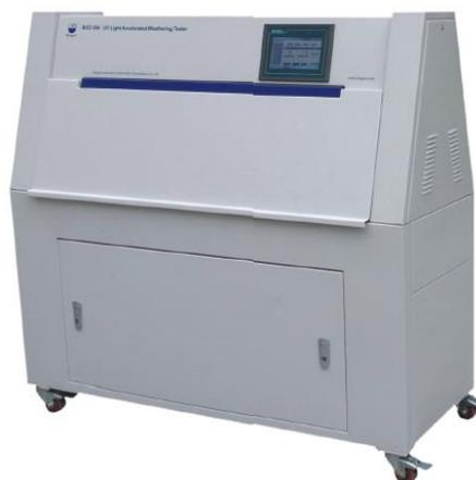
Ультрафиолетовые лучи солнечного света являются основным фактором, который негативно влияет на устойчивость большинства материалов к атмосферным воздействиям. В зависимости от различных требований испытаний, выбирают УФ лампы различной длины волны, это
