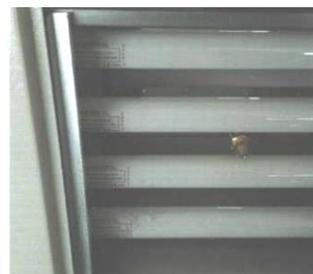
Люминесцентное УФ-излучение может моделировать эффект солнечного света, в то время как система конденсации и распыления воды может имитировать эффекты дождя и росы. Во время испытания энергия излучения и температура контролируются.
