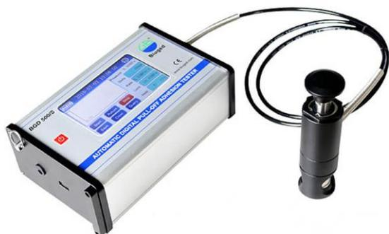
Цифровой адгезиметр на отрыв BGD 500/S – это портативный прибор с автоматическим управлением, который используется для измерения силы, необходимой для отрыва от подложки с применением гидравлического давления. Показания давления выводятся на ЖК-дисплей и означают силу адгезии покрытия к подложке.
