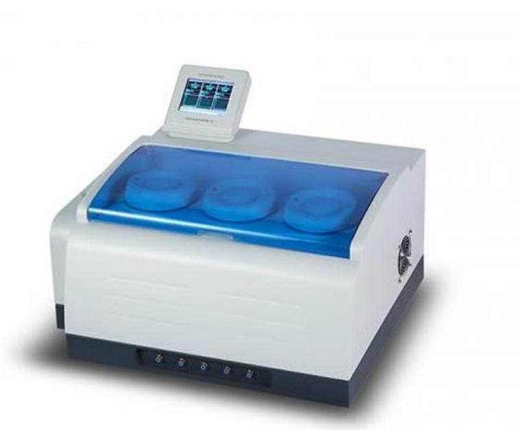
**Анализатор паронепроницаемости W413** предназначен для определения скорости пропускания водяного пара (СПВП) пленок или листовых материалов по принципу гравиметрического метода для пищевой и фармацевтической промышленности.
