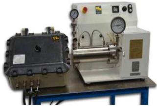
Универсальная лабораторная мельница SUPERMILL может быть использована с разными мелющими барабанами, объемом 0,5 л, 1 л, 1,5 л, которые также как мелющие диски и отсекаТЕЛЬ изготовлены из износостойкой стали.
