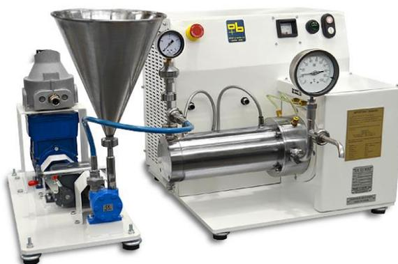
Лабораторная горизонтальная мельница SUPERMILL – идеальный вариант для лабораторных исследований и для перемола небольшого количества продукта. Машина не только дает возможности разработки новых формул, но также обеспечивает условия для подбора наиболее подходящих средств и скорости для индивидуального применения. Достигнутый успех в результате исследований максимально сопоставим с результатами, полученными в процессе промышленного производства на поставляемых горизонтальных бисерных мельницах.
