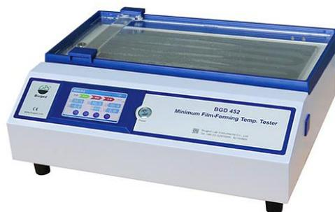
**BGD 452** — это новейший прибор, разработанный компанией Viuged для точного определения минимальной температуры пленкообразования, которая является важнейшим параметром для производства вододисперсионных красок, клеев, полимеров.
