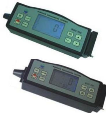
Тестеры шероховатости BGD 930/931 поверхности широко используются на производственных площадках для измерения шероховатости поверхности различных обрабатываемых поверхностей и деталей, для расчета и отображения всех параметров измерения.
