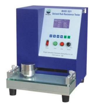
Тестер сопротивления истиранию с растворителем BGD 521 (МЭК тестер) разработан в соответствии с ASTM D 4752 и NCCA11-18. Тест на истирание растворителем обычно выполняется с использованием метилэтилкетона (МЭК «бутанон») в качестве растворителя.
