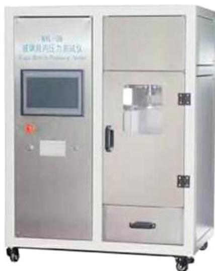
Тестер устойчивости внутреннему давлению для испытания стеклянных бутылок GBPI предназначен для испытания устойчивости давлению всех видов стеклянных бутылок: пивных бутылок, винных бутылок, бутылок для напитков, инфузионных бутылок, флаконов с антибиотиками и т.д.
