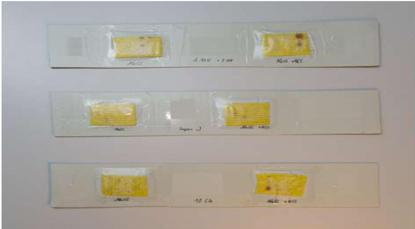
Образцы через 36 часов при 600 ° С, 5% -ном растворе NaCl и 5% -ном растворе NaCl + 0,1% моль / л раствора HCl. Зона царапин покрыта губкой.
